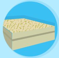
Ein Urethanschaum mit einer Dichte von 8 kg/m<sup>3</sup>, isoliert den Raum zwischen der Wanne und der Verkleidung.
